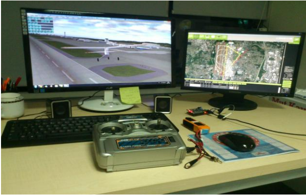
Şekil 6: Kurulan ve kullanılan donanımlı döngü tabanlı uçuş kontrol sistemi
