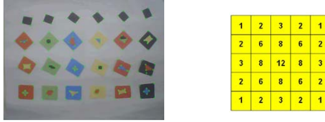
Şekil-1. Test görüntüsü ve katsayıları tamsayı olan gaussian penceresi
