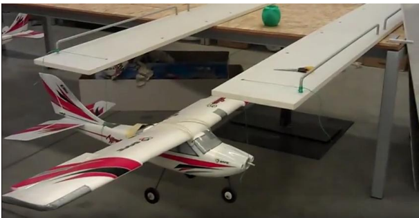
Şekil 2.1: Apprentice S model uçağı için çift telli sarkaç deneyi
